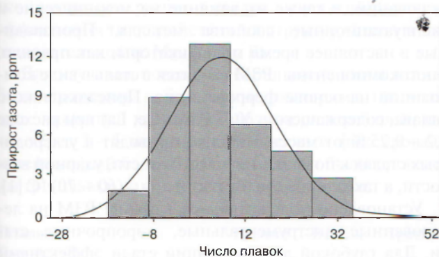
Рис. 4. Средний прирост азота после замены огнеупора и изменения конструкции защитной трубы 5,9 ppm: более 10 ppm — 14 плавков (35,5 %); от 5 до 10 ppm — 7 плавков (17,6 %); менее 5 ppm — 18 плавков (46,9 %)
