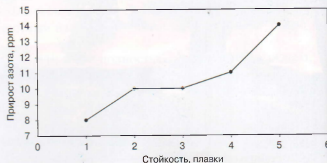
Рис. 1. Влияние износа огнеупоров на прирост азота
