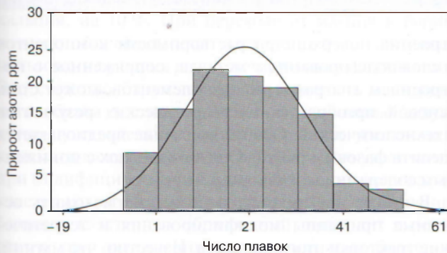
Рис. 3. Средний прирост азота до изменений 20 ppm: более 10 ppm — 83 плавки (76,2 %); от 5 до 10 ppm — 12 плавков (11,0 %); менее 5 ppm — 14 плавков (12,8 %)
